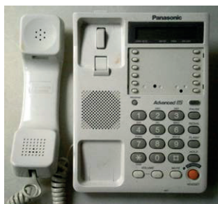
Figuur 6-19. Klassieke analoge 'draad' telefoon, magnetodynamisch luidsprekertje in de hoorn. Wordt door sommigen slecht verdragen
