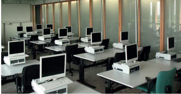
Figuur 6-35. Identieke workstations, alle aangesloten op hetzelfde elektrische net. Omdat de schakelende voedingen alle op hetzelfde moment vermogen uit het net opnemen, ontstaan er een sterke stroomvervuiling.
