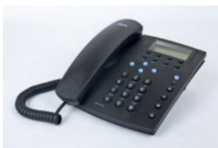
Figuur 6-20. Piëzo draadtelefoon (Litephon). Analoge telefoon met piëzo element in de hoorn, welke nauwelijks laagfrequente velden genereert. Wordt goed verdragen.
