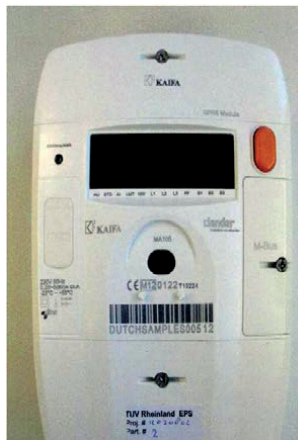
Figuur 6-24. Slimme meter KAIFA DSMR4.0. GPRS transmissie. Dit type dient als uitgangspunt voor het definitieve type.
