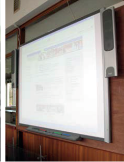
Figuur 6-36. Smart board waarop PC beelden worden geprojecteerd. Elektronische 'krijtjes' vormen de interface tussen leraar en het smart board.
