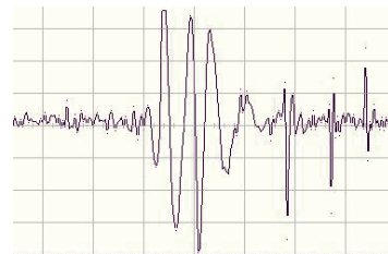
Figuur 6-11. Een 5x uitgerekte pulscluster. Let op de korte duur van de pulsen, nl. ca 0,5 milliseconde ( notatie: msec. ). Tijdas 1 msec.
