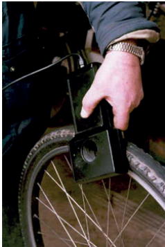
Figuur 6-40. Magnetische zones in staaldraad van fietsbanden. Demagnetiseren m.b.v. een 50 Hz demagnetisatie apparaat.
