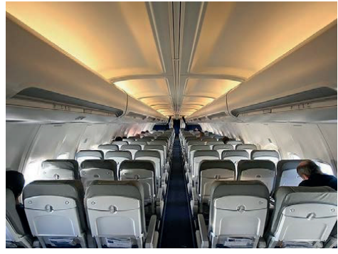
Figuur 6-42. Vliegtuig compartiment. De meeste datakabels liggen boven het plafond. De sterkste laagfrequente velden heersen direct onder het plafond.
