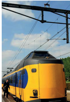
Figuur 6-41. Trein die bij het optrekken en elektrisch afremmen sterke laagfrequente pulsen op de bovenleiding zet.
