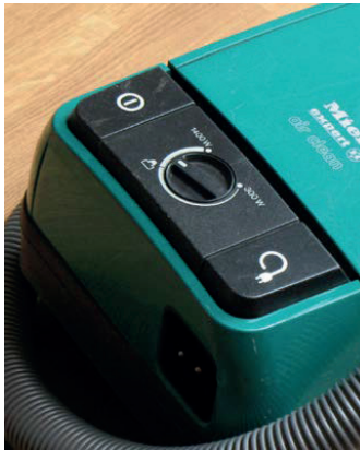
Figuur 6-14. Stofzuiger, een van de vele huishoudelijke apparaten met een regelbaar vermogen, hier ingesteld op ca. \frac{1}{4} vermogen.
