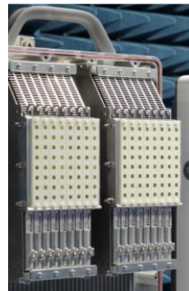
Figuur 3. Dubbele 5G zendantenne, elk met 64 elementen. Bron: Ericsson Stockholm
