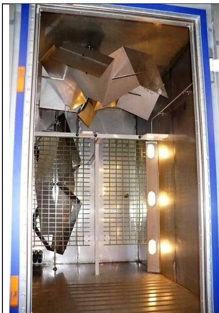
Figuur 1. Eén van de 14 'anechoische reverberation chambers' met bewegende metalen reflectoren voor veldegalisatie. Ratten hadden hierin grote bewegingsvrijheid [2].
